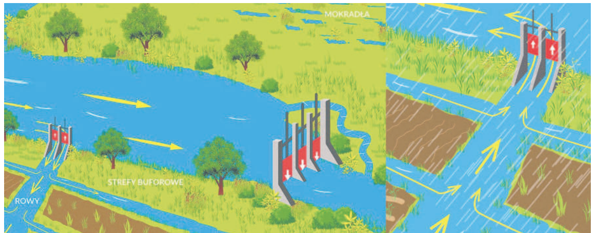
Rys. 1–2. Retencja korytowa w zlewni rolniczej pokazana na rzece o znacznym przepływie. Urządzenie piętrzące – jaz retencjonuje wodę w korycie na odcinku połączonym z systemem rowów, dzięki czemu możliwe jest wprowadzenie wód do systemu rowów, zatrzymanie ich dzięki mniejszym obiektom piętrzącym na czas niżówek oraz bezpieczne odprowadzenie wód w czasie opadów.
